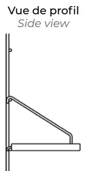
Placez les planches de telle sorte que les 2 taquets situés aux 2 extrémités de la planche soient bloqués à l'intérieur des intervalles formés par les tiges verticales de la base murale.
