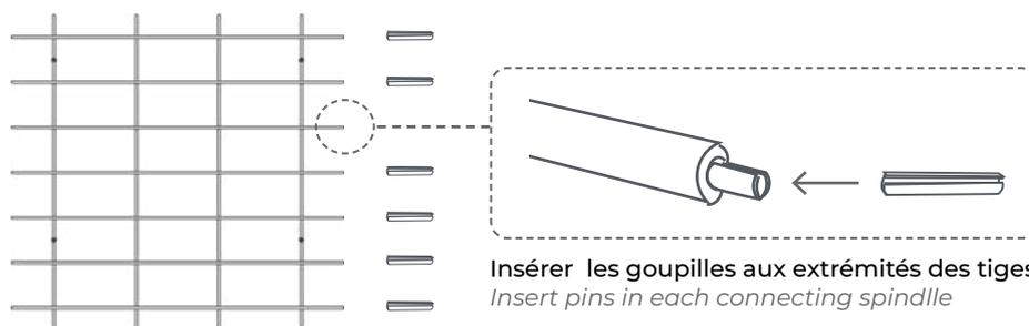
Insérer les goupilles aux extrémités des tiges de connexion
